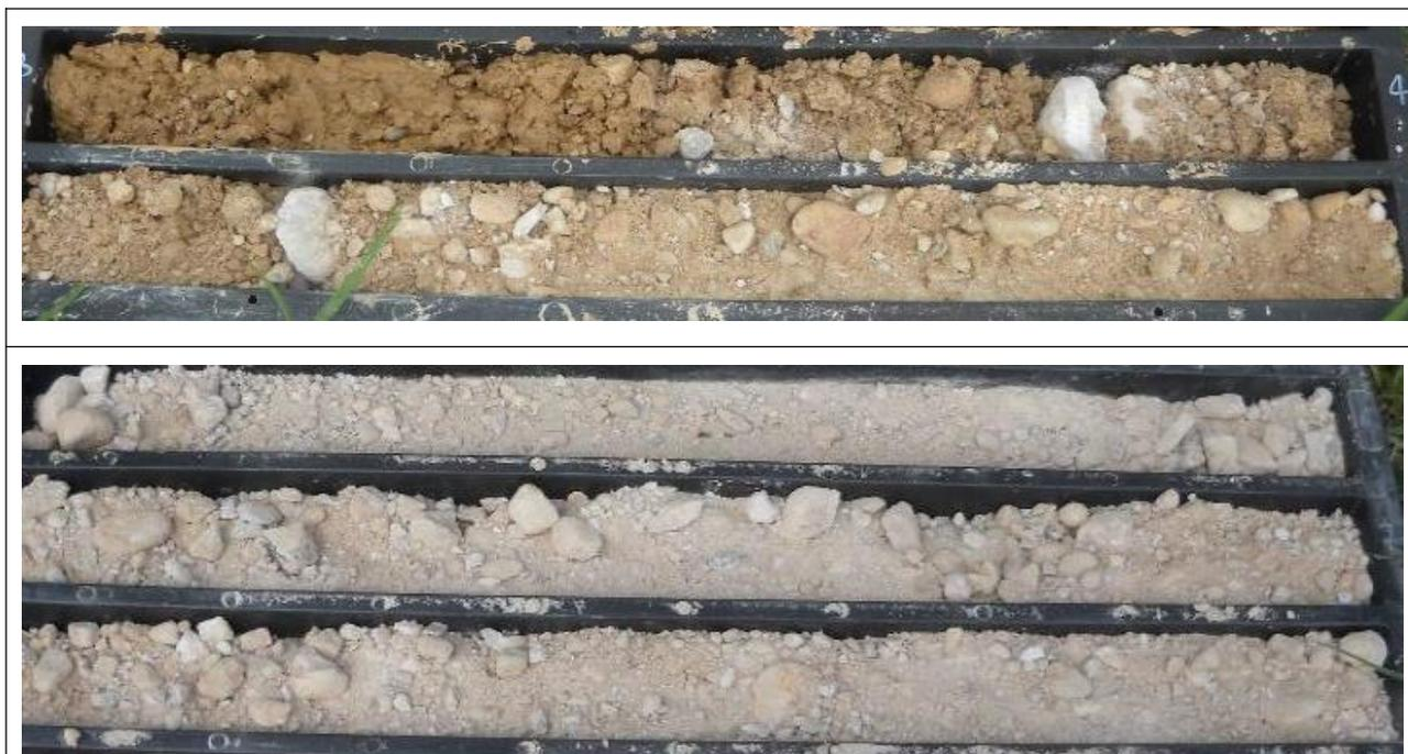
Figura 5: fotografia della cassa catalogatrice n° 2 – Sondaggio S 01 – da 3,00 m a 5,00 m e da 5,00 a 8,00
