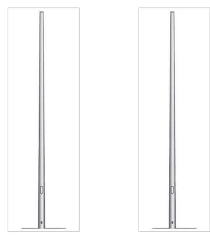
Palo conico ERW in acciaio S235JR laminato a caldo, 8800x148x60x4, entrata cavi, m.a.t., asola 186x46, zincato. Palo conico ERW in acciaio S235JR laminato a caldo, 9800x158x60x4, entrata cavi, m.a.t., asola 186x46, zincato.
