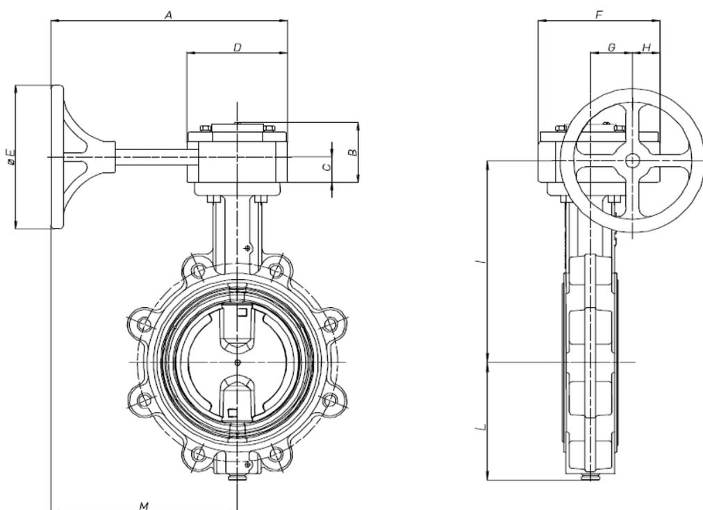
Meccanismo di concezione funzionante tramite pignone dentato e vite senza fine.
