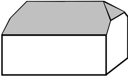
A1.2 : a padiglione con falde accorciate in cui le falde triangolari di testata mantengono una pendenza inferiore a quelle principali. La linea di gronda non e' piu' perfettamente chiusa e nemmeno disposta sul medesimo piano orizzontale.
