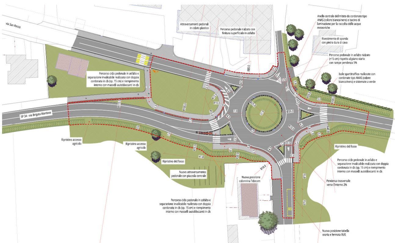
Figura 7: Nuova rotatoria di progetto.
