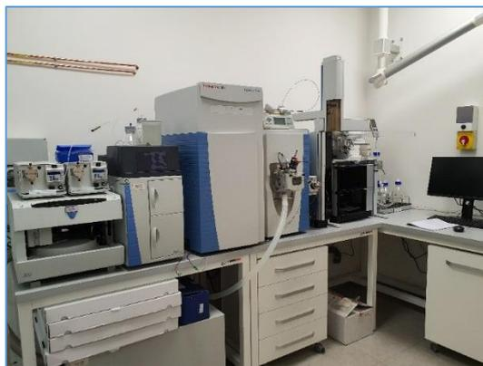
Spettrometro di massa ad alta risoluzione (UPLC/U-HPLC)
