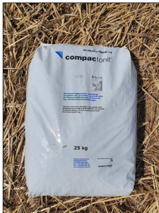
Foto 7: Bentonite di sigillatura del foro di sondaggio S1
