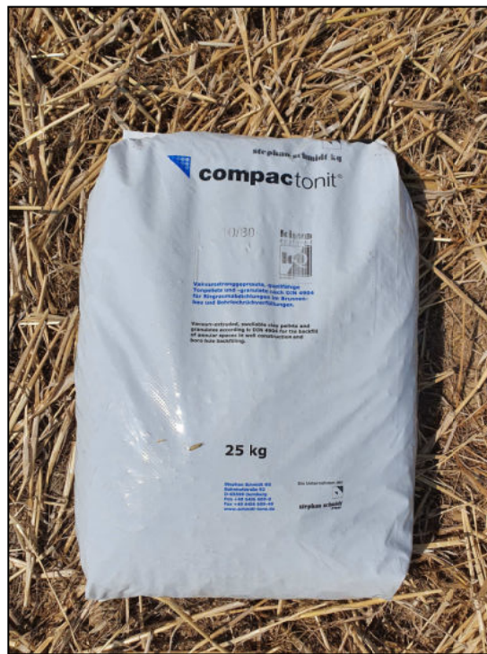
Foto 4: Bentonite di sigillatura del foro di sondaggio S1
