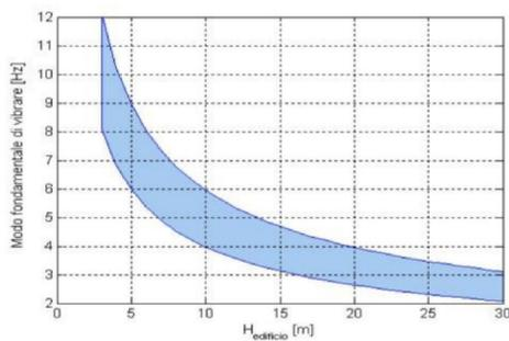
Esempio di correlazione tra altezza dell'edificio e frequenza di risonanza dei fabbricati, ai fini della valutazione degli effetti di doppia risonanza in caso di sisma.
