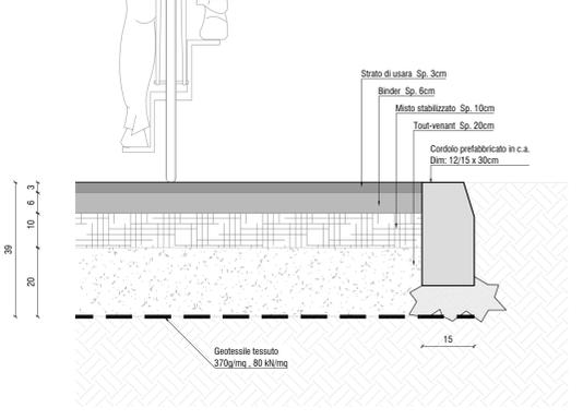
PARTICOLARE PACCHETTO DI PAVIMENTAZIONE DI PROGETTO Scala 1:10
