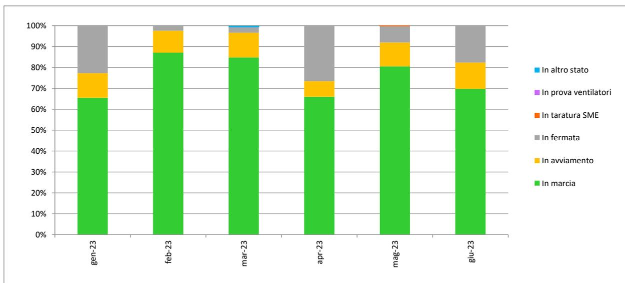
Figura 1.3 – Stati dell’impianto di fusione e affinazione in siviera nel 1° semestre 2023
