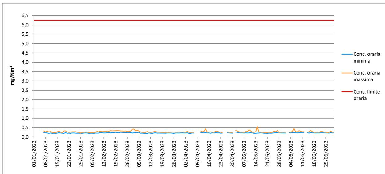
Figura 1.2 – Andamento dei valori minimi e massimi della concentrazione media oraria delle “Polveri” nel 1° semestre 2023
