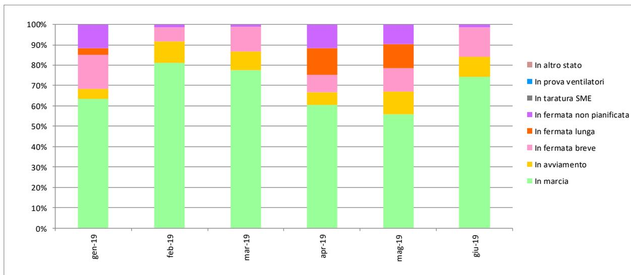
Figura 1.3 – Stati dell'impianto di fusione e affinazione in siviera nel 1^ semestre 2019
