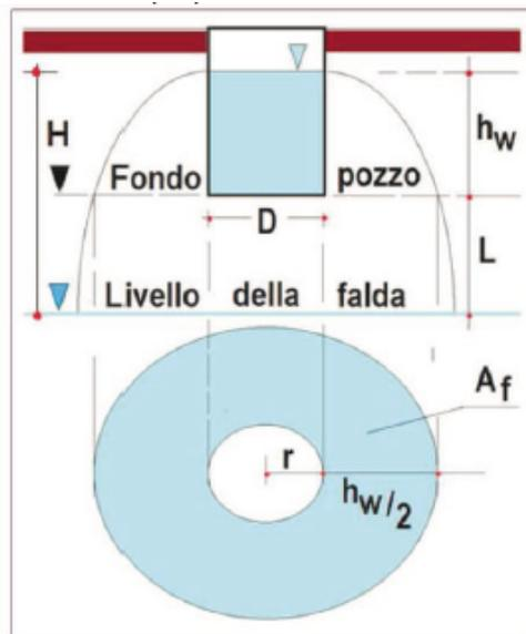
Schema di pozzo d'infiltrazione secondo F. Sieker
