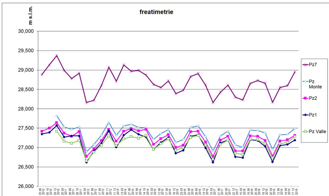
**Figura 7 - Quote rilevate nei piezometri superficiali in m s.l.m.**
