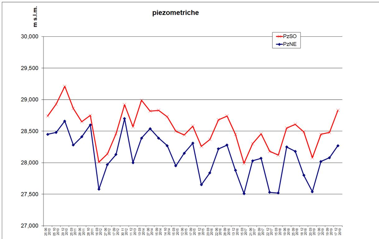
**Figura 8 - Quote rilevate nei piezometri profondi in m s.l.m.**
