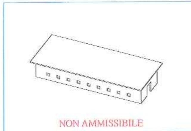
Non sono mai ammissibili i fabbricati con copertura piana, derivati per dimensioni e tipologia costruttiva da modelli industriali del tutto estranei al paesaggio agrario. In particolare è da evitare il ricorso sistematico a tamponamenti che portano in vista strutture, quali travi e pilastri in c.a. precompresso, svilenti per l'immagine rurale tradizionale.
