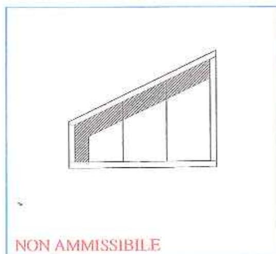
Non è ammessa la realizzazione di finestre o porte-finestre, poste ad angolo degli edifici, come illustrato nell'esempio qui sotto.
