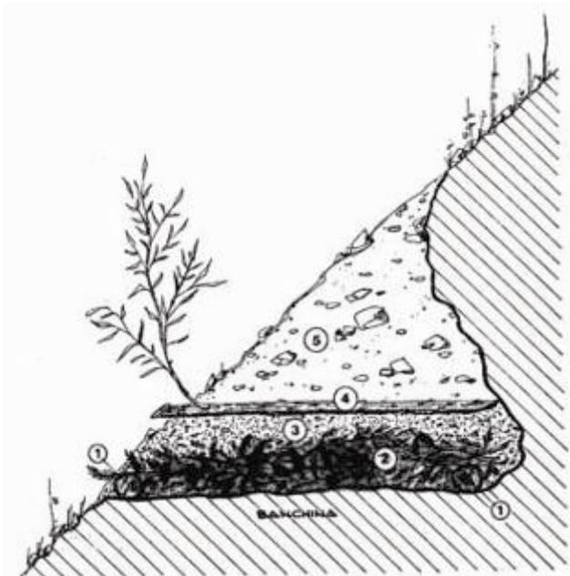
Schema di realizzazione di una cordonata (A.R.P.A.V.)
