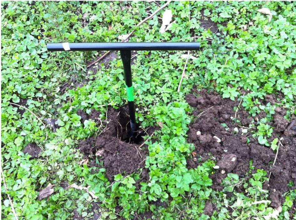
**Foto 1** – Esecuzione della verticale di indagine/campionamento, mediante coclea in metallo a vite senza fine.
