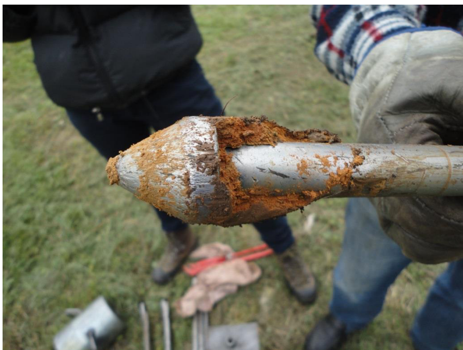
foto 2 – Particolare della punta estratta dalla seconda prova penetrometrica dinamica con dispositivo mod. Penny.
