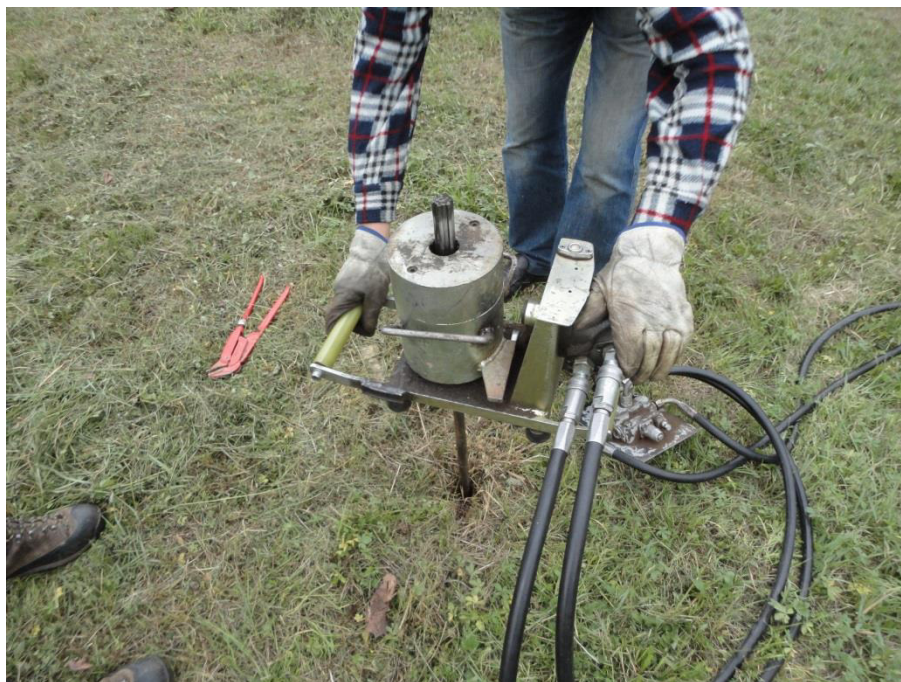
foto 1 – Esecuzione della prima prova penetrometrica dinamica con dispositivo mod. Penny.
