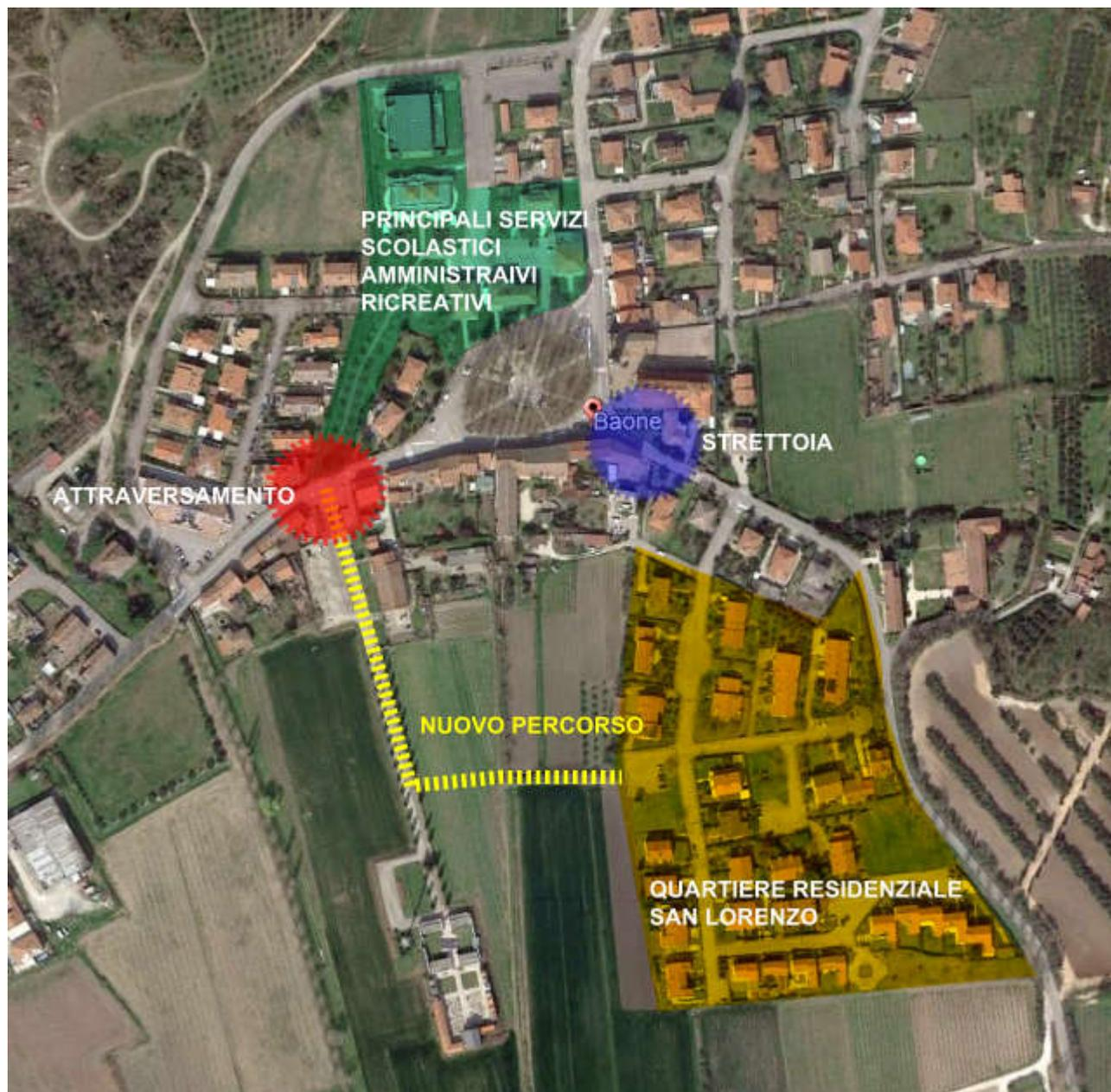
Per il nuovo tracciato si propone di percorrere in parte i "caresoni" esistenti, al fine di limitare l'interferenza con l'integrità della trama fondiaria, rispettando così anche l'assetto paesaggistico che con l'intervento potrà essere anche valorizzato in termini di fruibilità generale.
