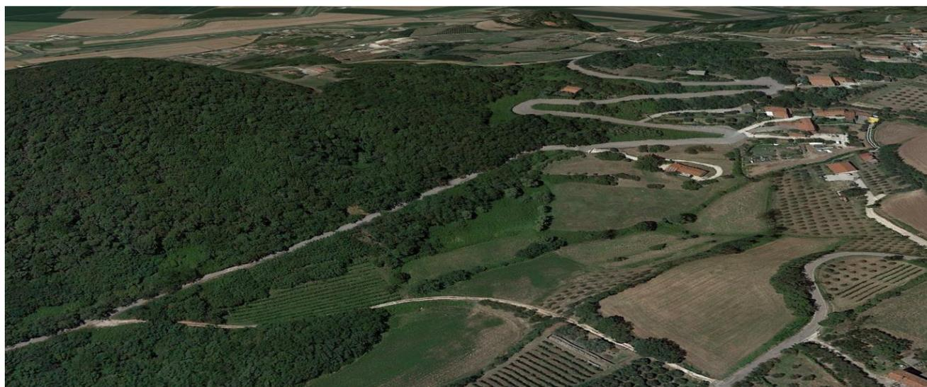
*Foto del sito d'indagine in cui è evidente l'azione antropica dell'uomo che consiste nello sbancamento e muri di sostegno (riprofilatura del versante) per la realizzazione della strada; a cui si sono aggiunte nel tempo alcune costruzioni rurali e civili.*
