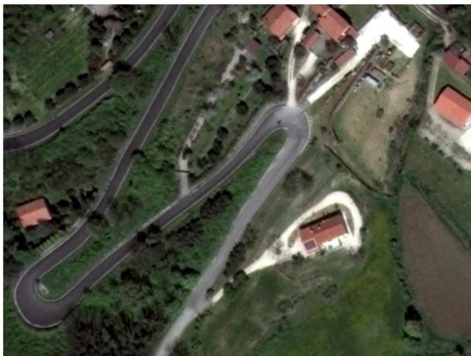
*Ortofoto 2011 l'interna via Spiasi è stata asfaltata (salvo la parte più a SO dell'abitazione); nel frattempo è stata realizzato l'ampliamento dell'abitazione posta a valle di via Spiasi (si notano i pannelli fotovoltaici); per questo ampliamento è stata realizzata un'indagine specifica nel luglio 2009*
