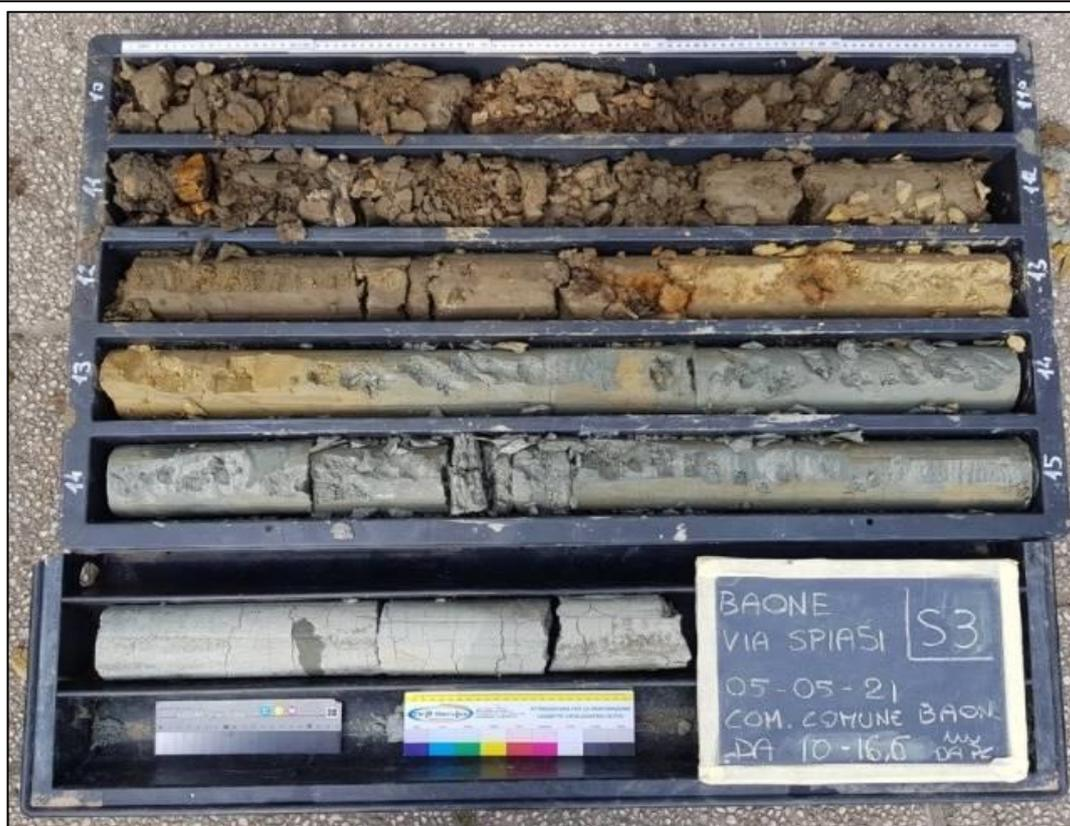
Cassetta catalogatrice del sondaggio S3; da 10.0 a 15.6 m da p.c.
