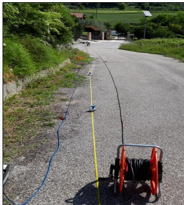
*Traccia del profilo sismico*
