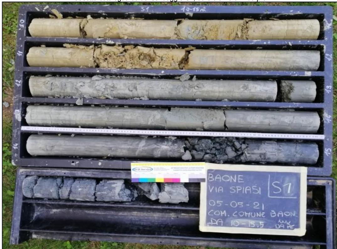
Cassetta catalogatrice del sondaggio S1; da 10.0 a 15.5 m da p.c.
