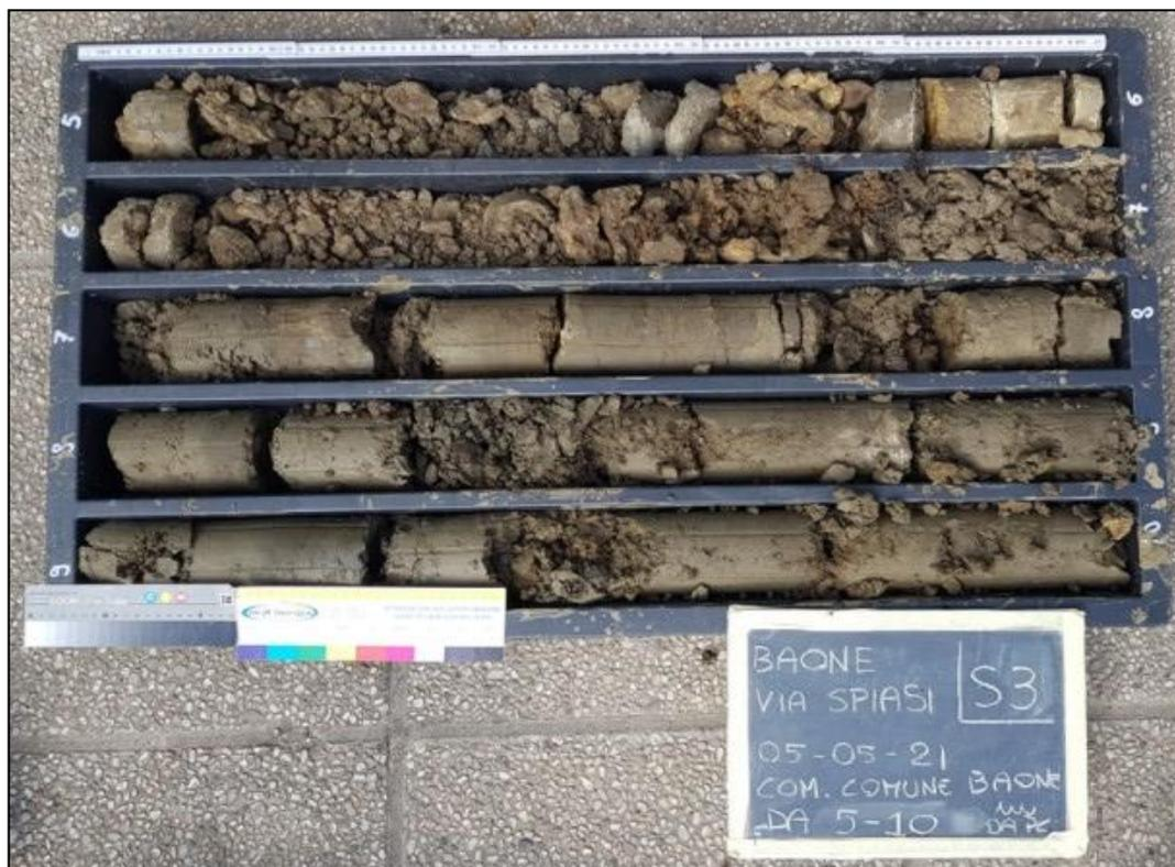
Cassetta catalogatrice del sondaggio S3; da 5.0 a 10.0 m da p.c.
