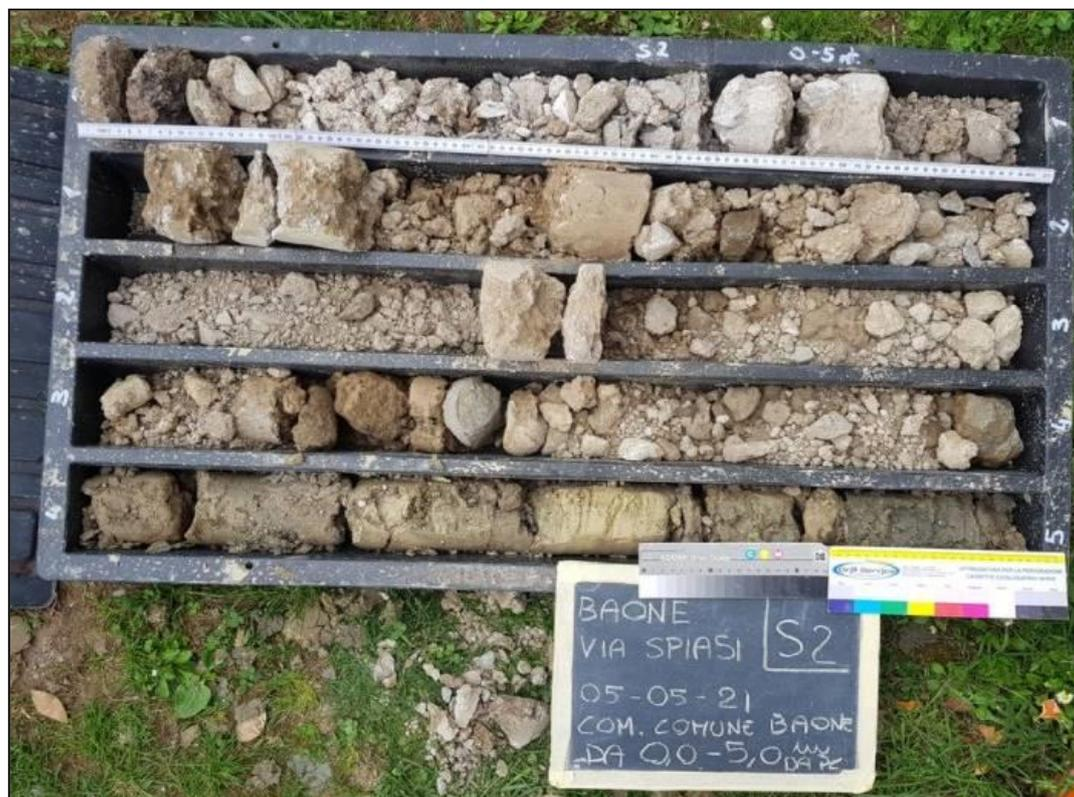
Cassetta catalogatrice del sondaggio S2; da 0.0 a 5.0 m da p.c.
