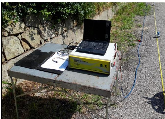
*Strumentazione utilizzata per l'indagine sismica*
