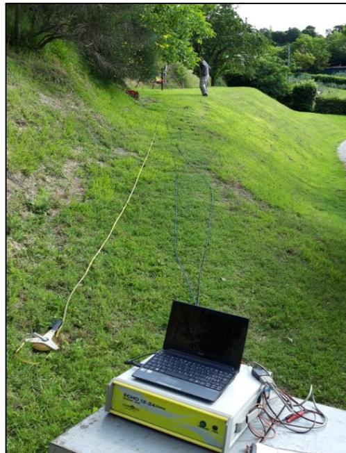
*Traccia del profilo sismico*
