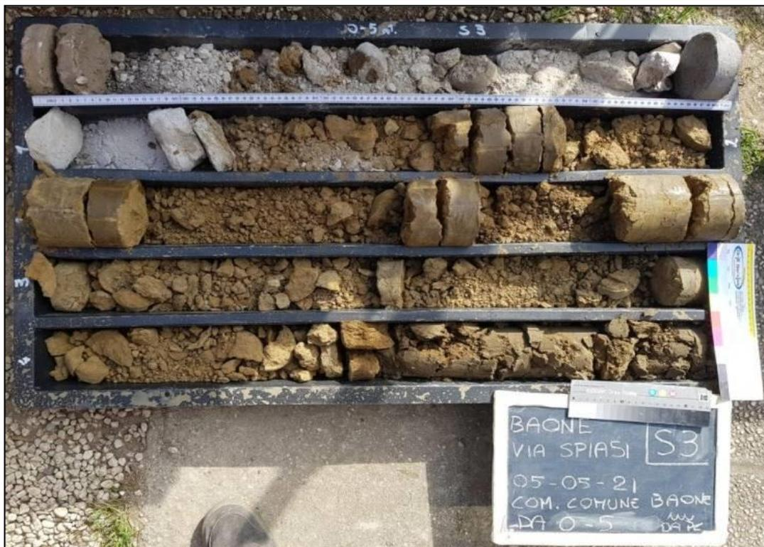
Cassetta catalogatrice del sondaggio S3; da 0.0 a 5.0 m da p.c.
