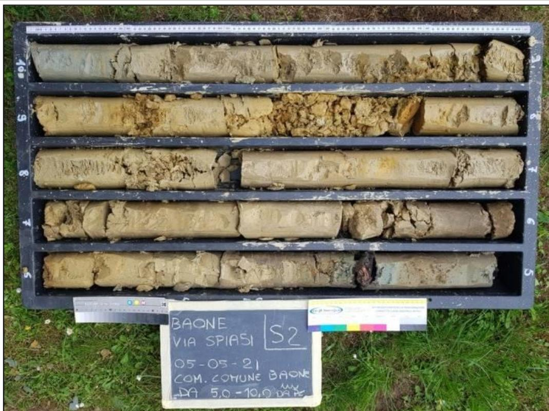
Cassetta catalogatrice del sondaggio S2; da 5.0 a 10.0 m da p.c.
