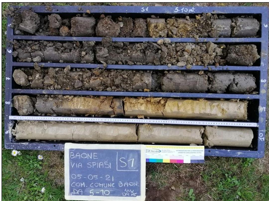
Cassetta catalogatrice del sondaggio S1; da 5.0 a 10.0 m da p.c.
