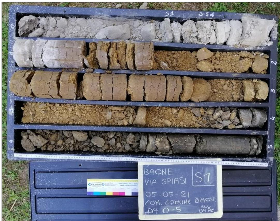
Cassetta catalogatrice del sondaggio S1; da 0.0 a 5.0 m da p.c.
