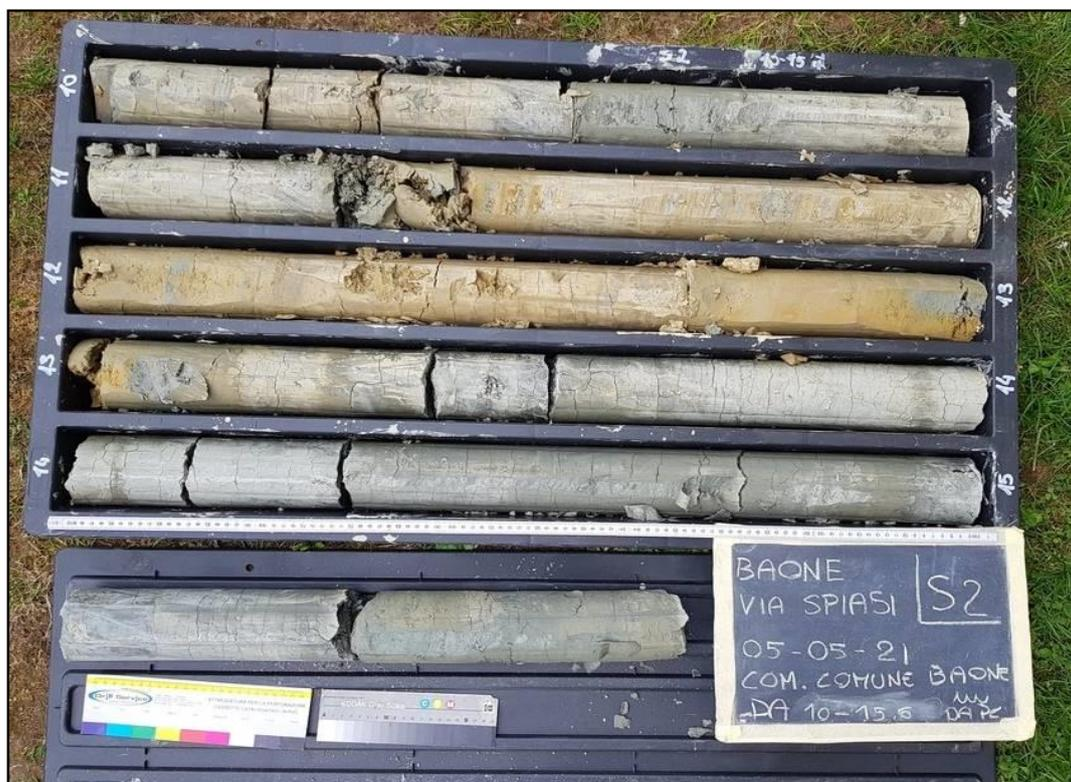
Cassetta catalogatrice del sondaggio S2; da 10.0 a 15.5 m da p.c.
