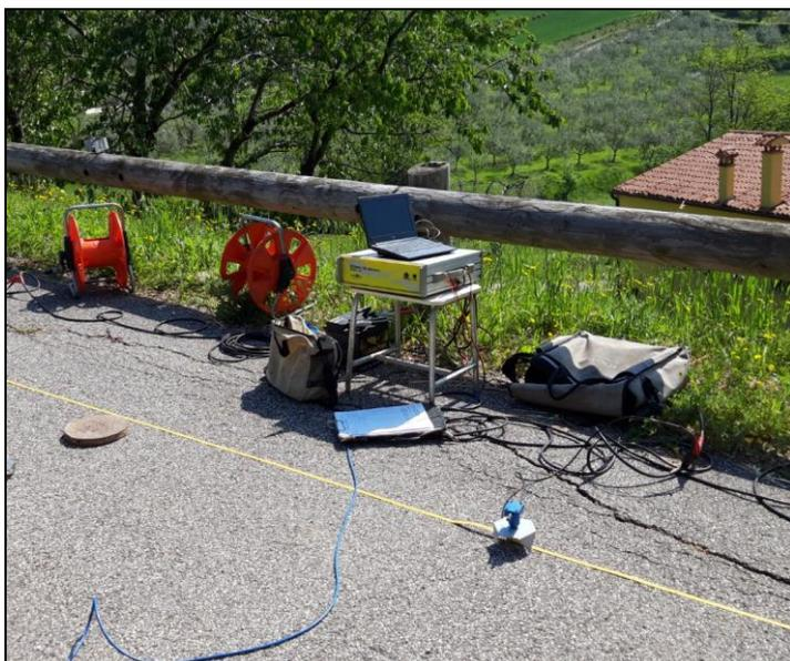
*Strumentazione utilizzata per l'indagine sismica*
