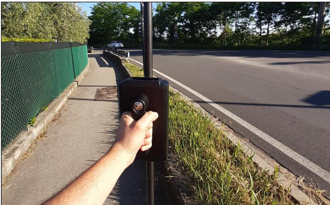
*Foto operatore durante acquisizione in campo tramite magnetometro MagWalk*
