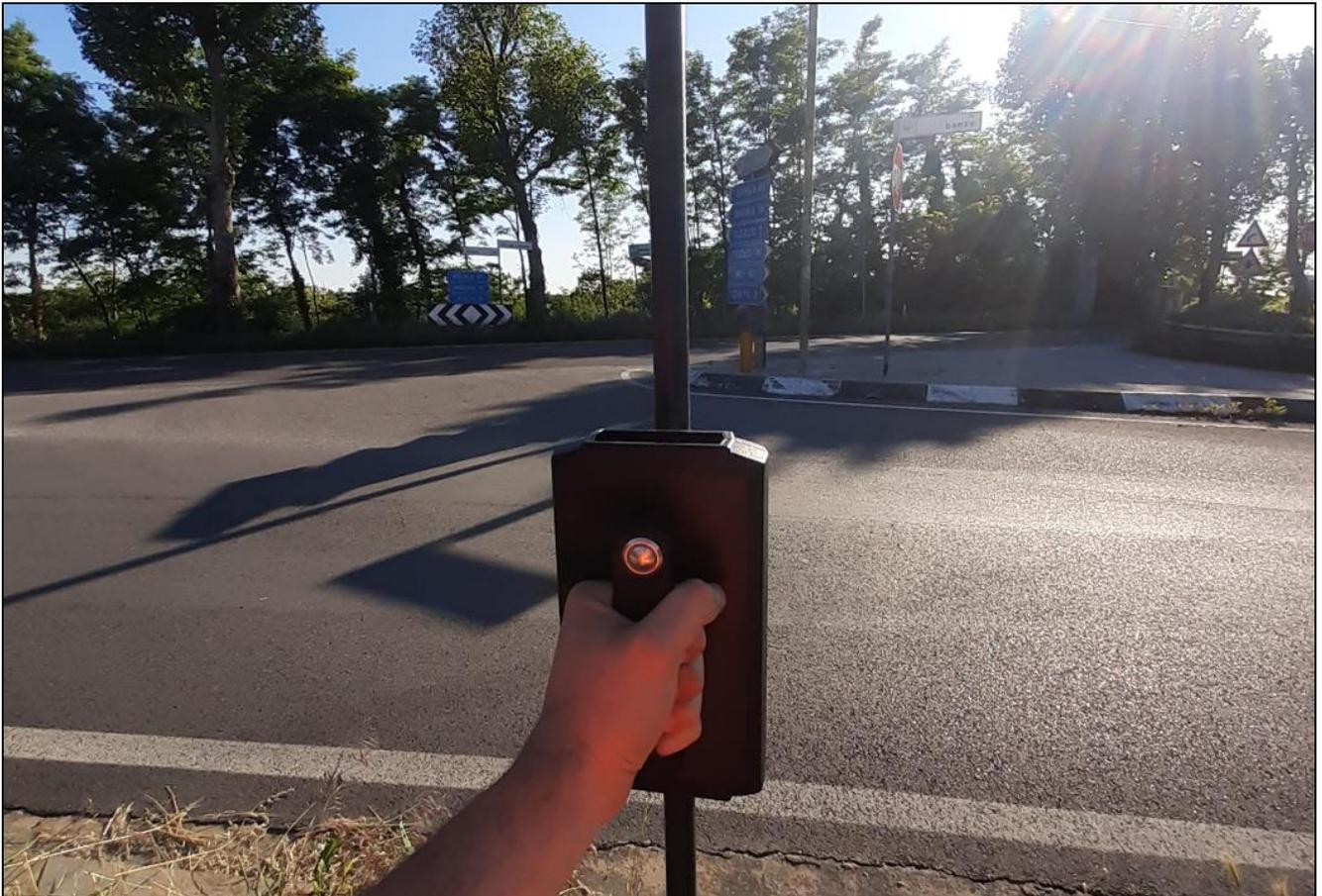
*Foto operatore durante acquisizione in campo tramite magnetometro MagWalk*
