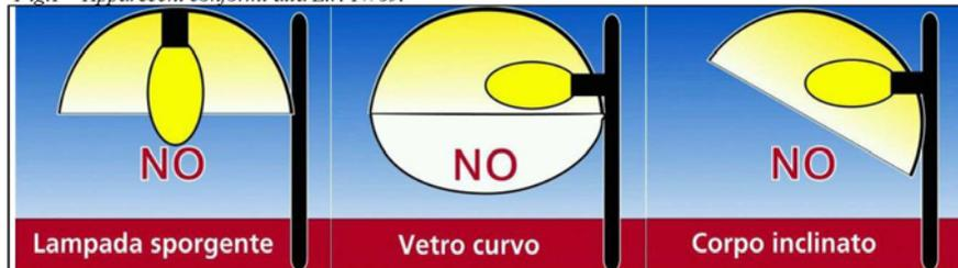
Fig.2 – Apparecchi che per configurazione non sono conformi alla L.r. 17/09.
