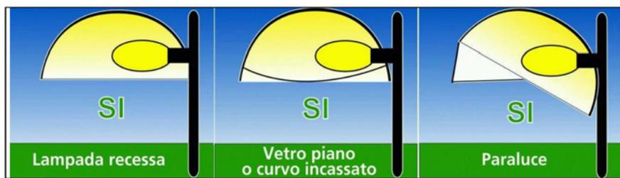
Fig.1 – Apparecchi conformi alla L.r. 17/09.
