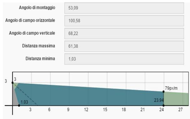
sito di installazione, schema risoluzione pixel/metro e dati tecnici di installazione
